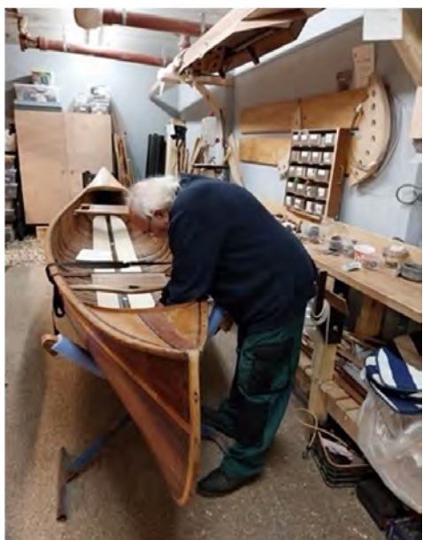
Pose du plancher par maître Guy d'Houilles
