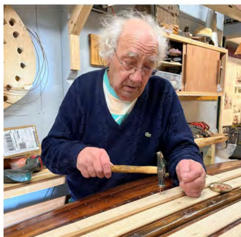
Guy d'Houilles pose les quilles d'échouage
