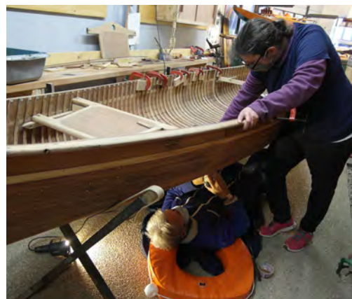
Pose et assemblage de membrures d'acacia avec la technique du clou agrafé
