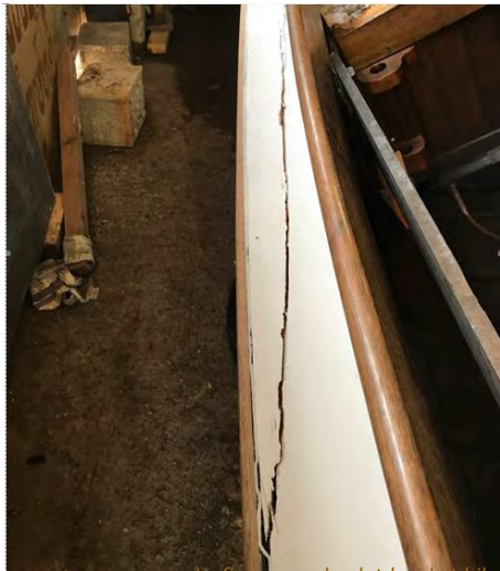
La fissure sur le plat-bord et hiloire
