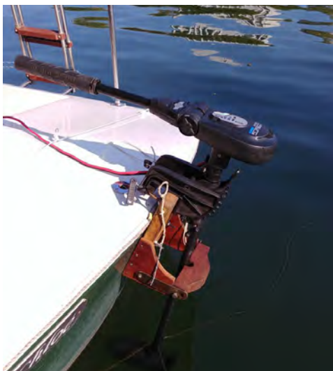
Moteur électrique hors-bord de secours
