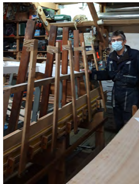
Montage et serrage de la muraille
