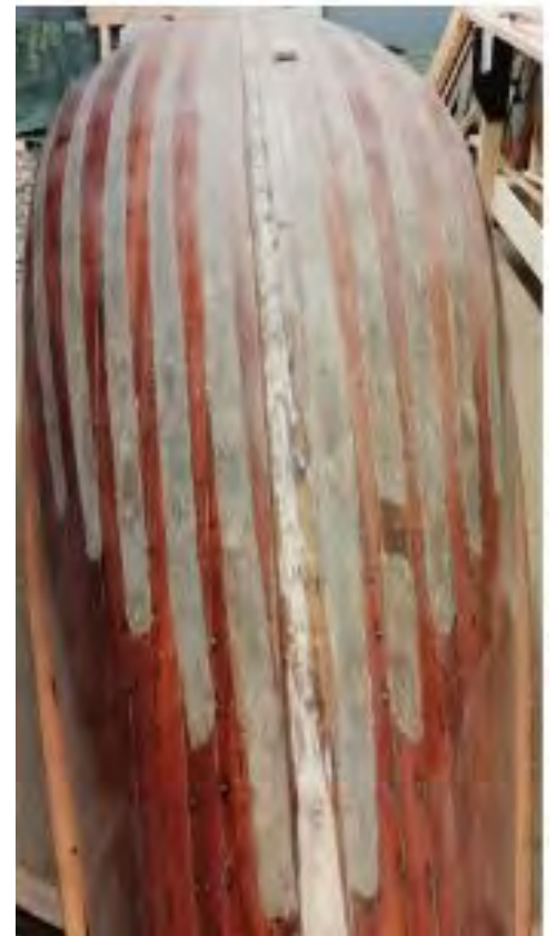
Les rails d'échouage otés avant décapage
