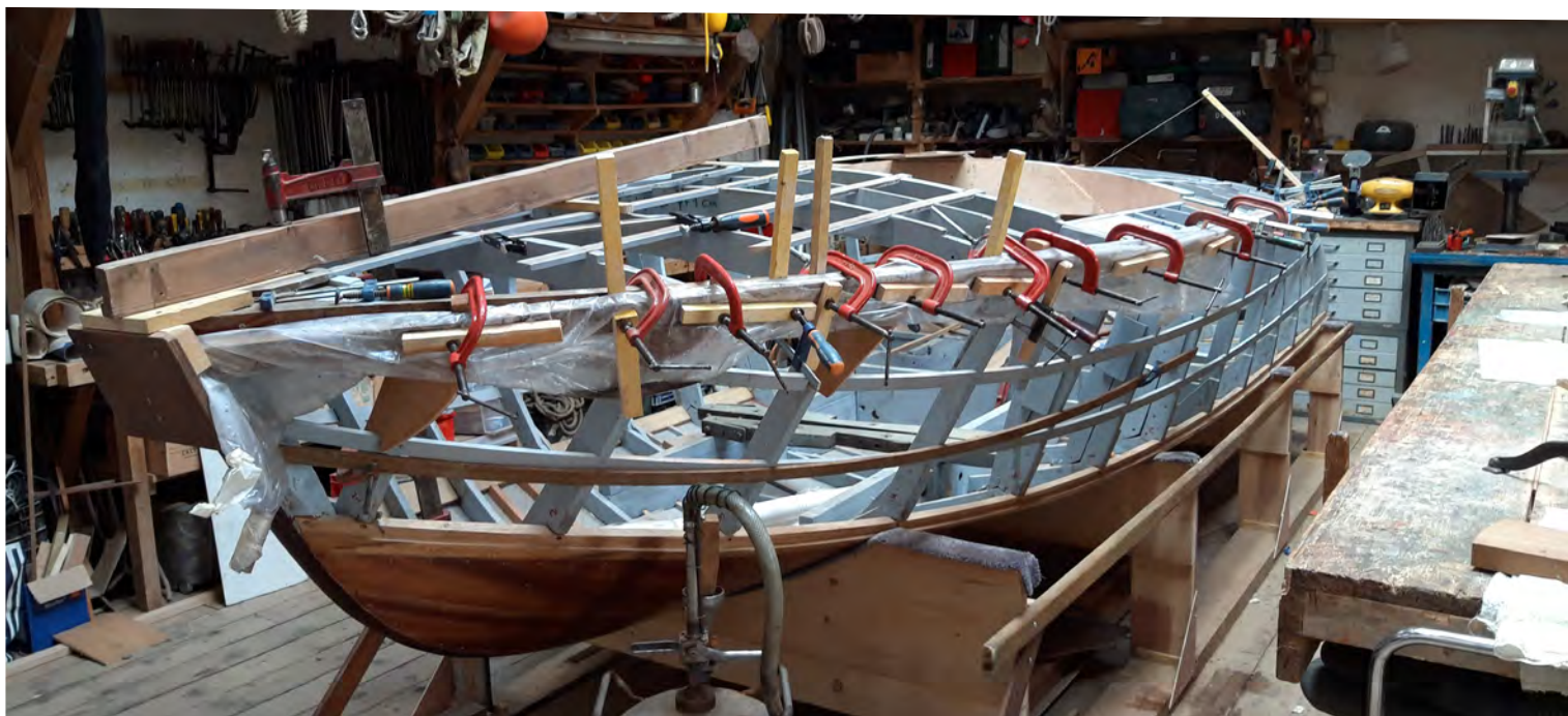
Cintrage à chaud de la serre-bauquière babord
