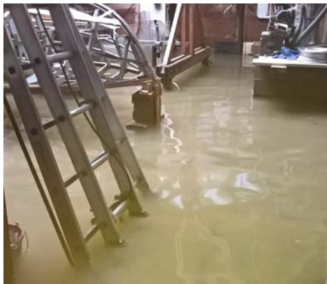
Tout ce qui craint est sur parpaings.
