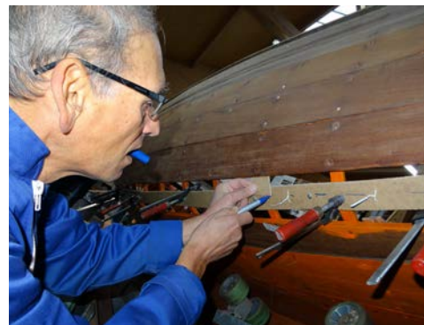
Opération de brochetage de virure
