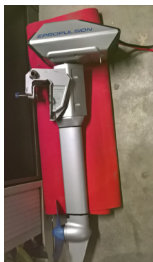
Ci-dessus : le moteur hors-bord électrique.
