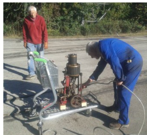
Dégraissage et nettoyage au karcher haute pression puis séchage à l'air comprimé
