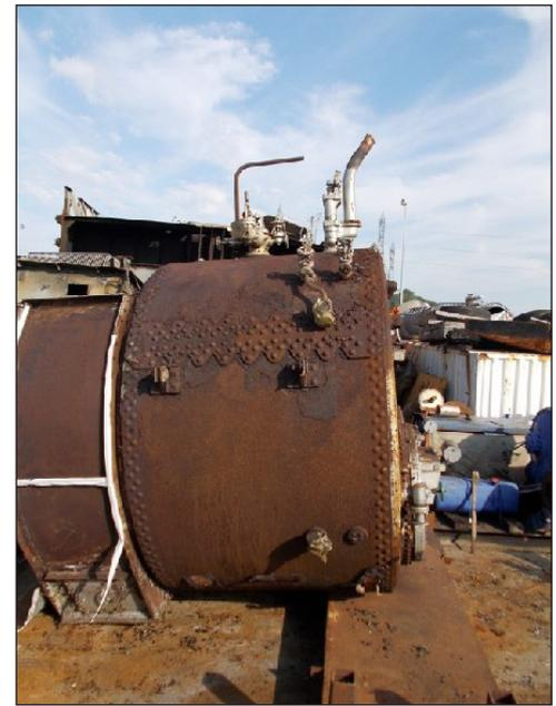
Vue latérale du corps de chauffe. Noter le chapelet de rivets qui ferme la virole. C'est du sérieux. Les joints d'amiante, nous a-t-on dit, se trouvent au niveau des bandes blanches (c'est leur signalment). Sur la photo on remarque une corrosion importante de la virole.
