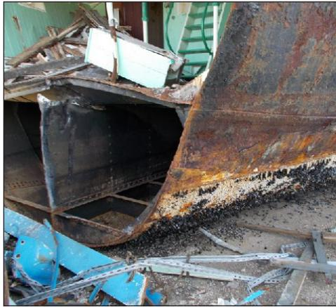
La coque a été jugée irrécupérable. Comme l'attestent ces photos, la corrosion est importante dans les œuvres vives (11 mm. à l'origine). La coque en acier riveté avait une épaisseur de 11 mm. dans les œuvres vives et 8 dans les œuvres mortes.
