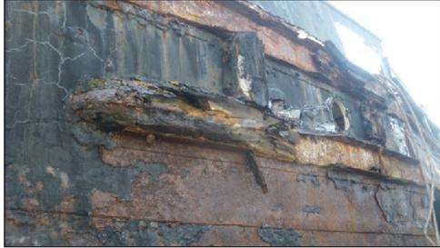
Au-dessus de la ligne de flottaison, voici ce qui reste de la lisse en bois (épaisseur initiale : 15 cm) permettant la mise à couple avec le navire ravi-taillé.
