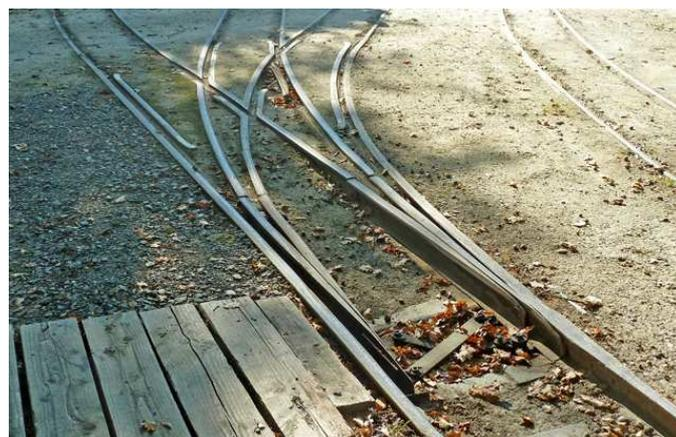
*CF de Rillé – Branchement triple enroulé en voie de 60*
