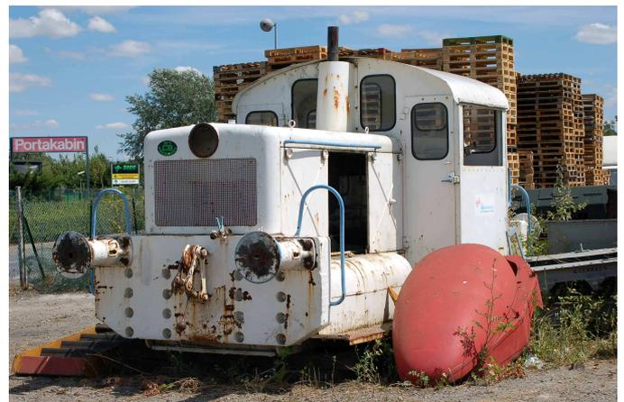
Et l'autre du type TE40, don des Établissements Clause de Brétigny-sur-Orge. Le plateau porte un conteneur pour réacteur d'avion fabriqué également par Decauville. Ils sont tous deux équipés d'un moteur diesel Berliet licence Ricardo.
