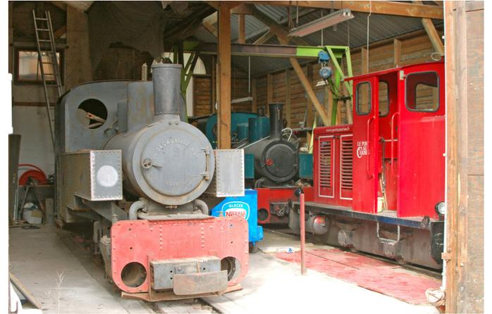
Toujours en voie de 60, la traction diesel est elle représentée par des tracteurs miniers : un TMB 15
